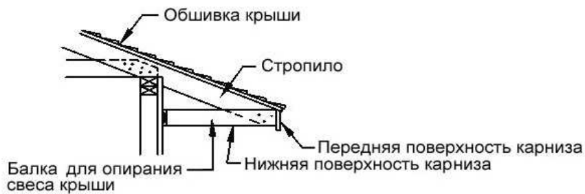
Выступающий свес карниза (из стропил)
