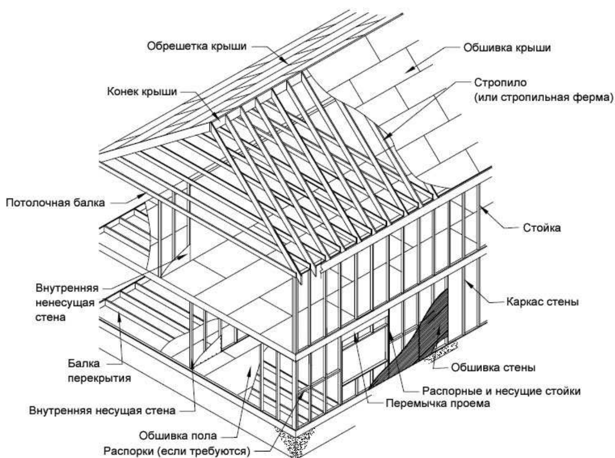
Рис. 4.1. Конструктивные элементы и связи каркасного деревянного дома
