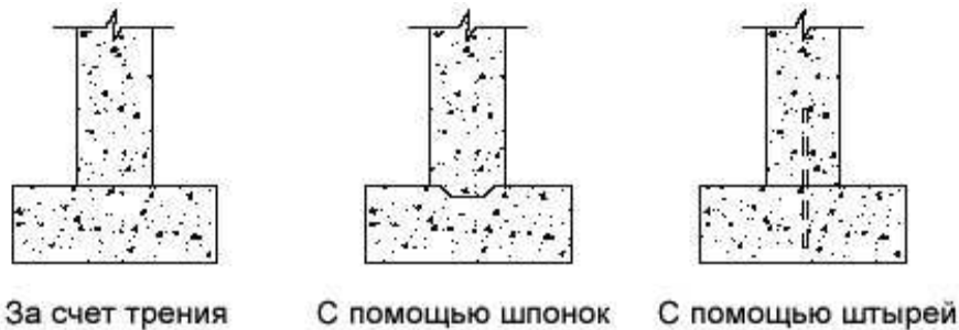
Рис. 5.7. Схемы соединений стен фундаментов с уширениями
