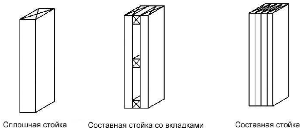
Рис. 4.5. Типы деревянных стоек
