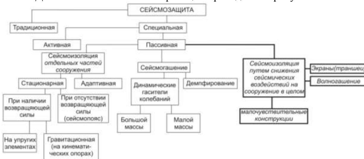
Рис. 2. Дополненная классификация систем сейсмозащиты по принципу их работы (курсивом выделены дополнения)
