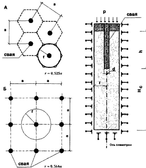
Рисунок 2 — Расчетная схема метода ячейки
