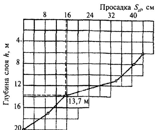
Рисунок Е.2 — График зависимости  $S_{sl} = f(h)$
