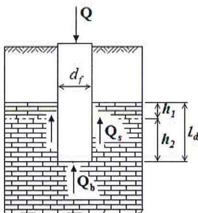
$Q$  – вертикальная нагрузка на сваю;  $Q_b$  – вертикальная нагрузка, воспринимаемая пятой сваи,  $Q_b/Q = \eta$ ;  $Q_s$  – вертикальная нагрузка, воспринимаемая боковой поверхностью сваи,  $Q_s/Q = 1 - \eta$ .
