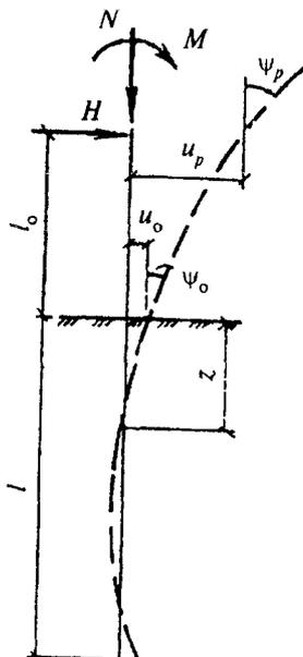
Рисунок В.1 — Схема нагрузок на сваю
