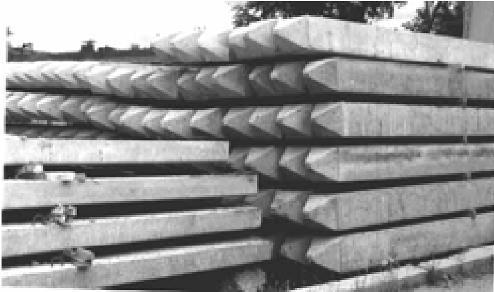
Рис. 4.6. Складирование свай из мелкозернистого бетона.
