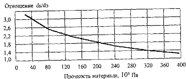
Рис. 1.11. Тарировочный график для молотка К.П. Кашкарова
